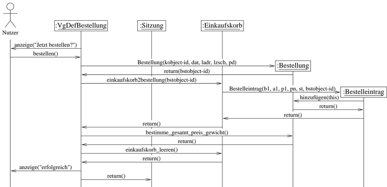
Abbildung 6.15: Sequenzdiagramm mit expliziten Objekterzeugungs-Zeitpunkten (Teil 3)
