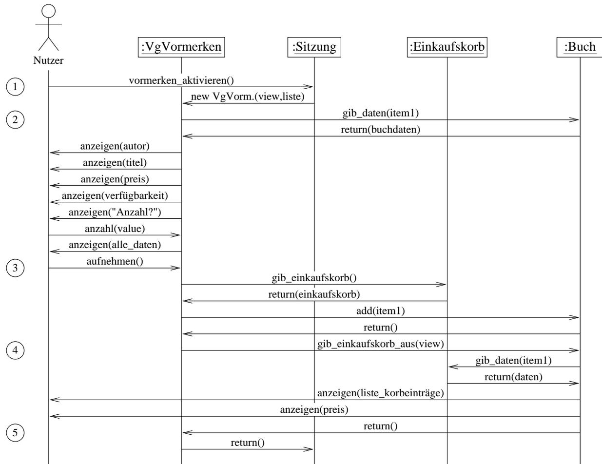
Abbildung 6.6: Sequenzdiagramm zum Nutzungsfall: Vormerken zum Kauf
