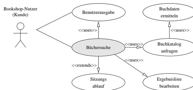
Abbildung 6.26: Nutzungsfalldiagramm: Büchersuche
