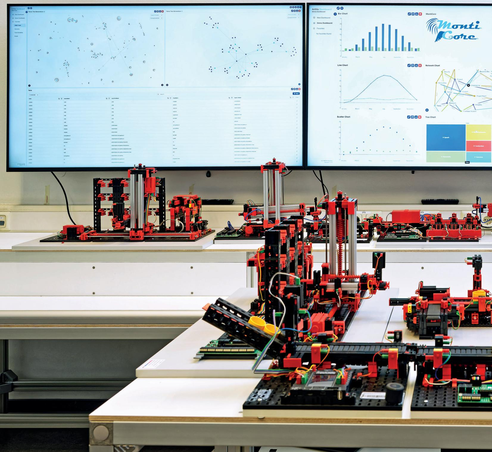
Bild 2: Modellgetriebene Analyse und Simulation einer Demofabrik
