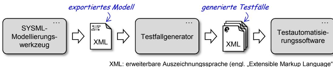
Abbildung 7.1: Vereinfachte Übersicht über den Prozess der automatisierten Testfallerstellung
