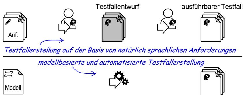
Abbildung 5.3: Vergleich der traditionellen Testfallerstellungsmethode mit der modellbasierten automatisierten Testfallerstellung mit SMArDT [DGH<sup>+</sup>19]
