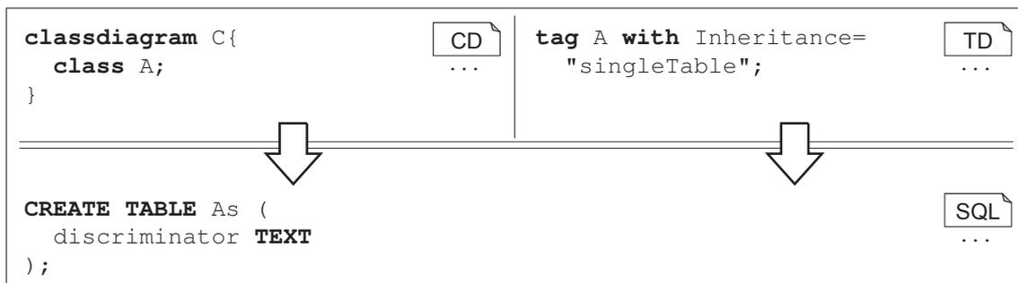
Abbildung 7.47: Abbildung des Inheritance Tags mit der `singleTable` Option im Generat des SQL-Generators.
