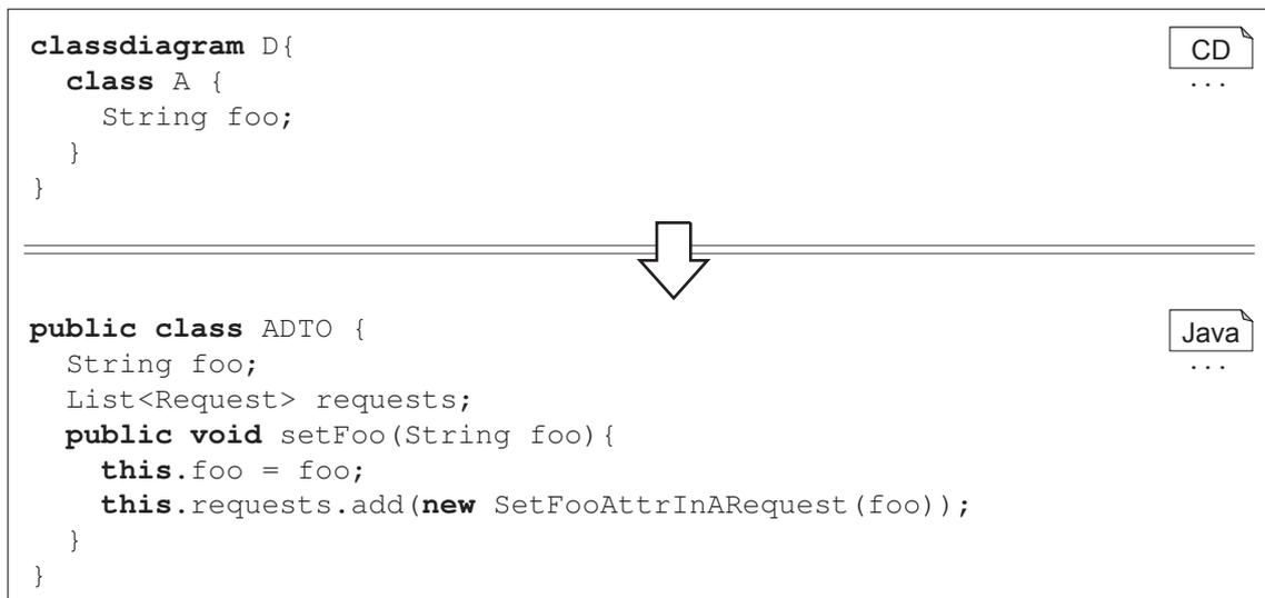
Abbildung 8.8: Darstellung der Objekterzeugung von Requests in den Setter-Methoden der DTOs.
