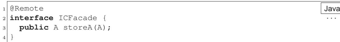
Listing 8.21: Darstellung des generierten Interfaces und der Annotation `@Remote` zur Realisierung einer RPC-Fassade.
