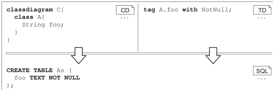
Abbildung 7.49: Abbildung des NotNull Tags im Generat des SQL-Generators.
