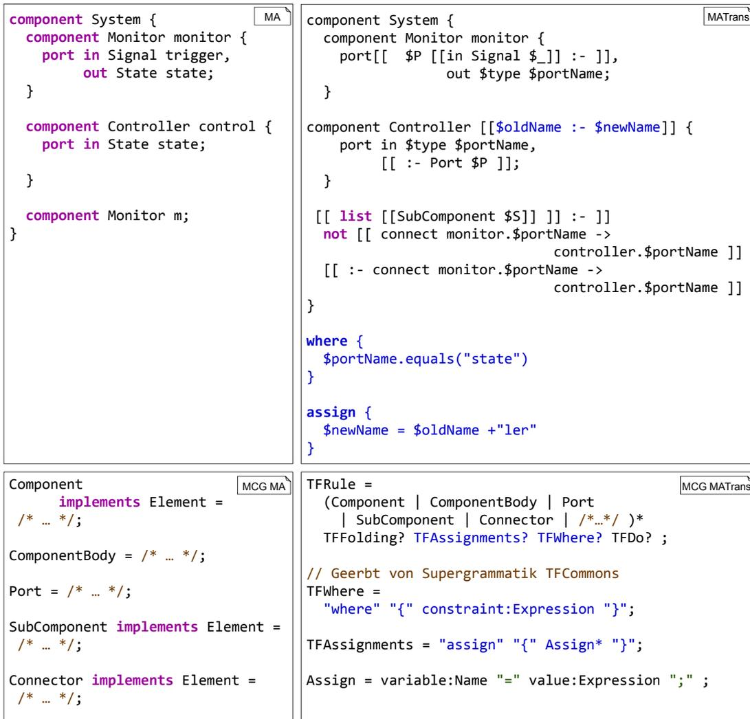
Abbildung 5.22: Einschränkung der Anwendbarkeit durch einen Application Constraint und Zuweisungen von Schemavariablen.
